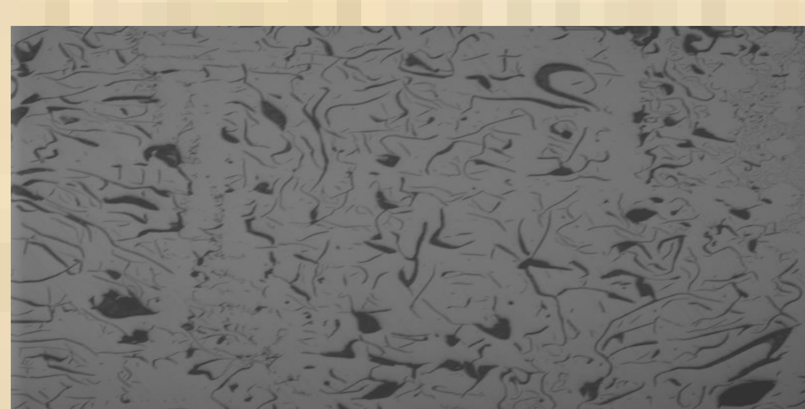
Rysunek 5.33 Powierzchnia żeliwa szarego EN- GJL -200, pow. x100
