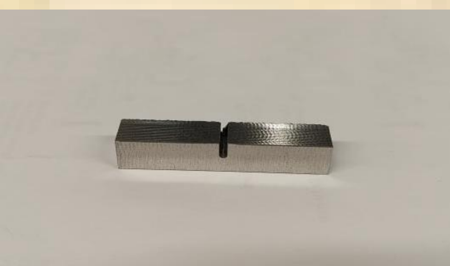
Rysunek 5.32 Nominalna próbka typu U do testu uderzeniowego
